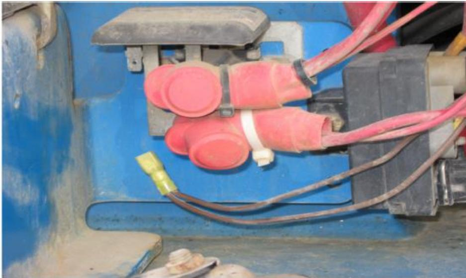
Debe escuchar un clic audible distinto suena cuando se desconecta este cable de la separador / aislador. Si no oyes un clic, esta es otro buen indicador que la batería. separador / aislador esta malo y drena o baja las baterías.
